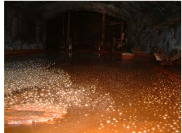
Kohlensäureaustritt in der Grube Neuheffnung (Bad Ems, Lahntal)
