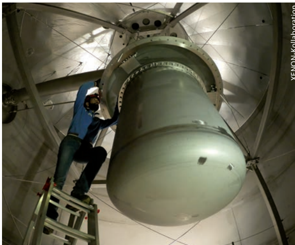
Abb. 7 Der Kryostat von XENONIT. Zur Abschirmung von Radioaktivität befindet sich das Experiment im Gran-Sasso-Untergundlabor in einem zehn Meter großen Wassertank.
