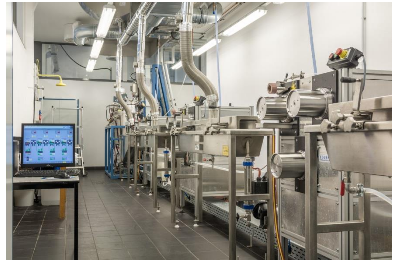
Lösungsmittelnassspinnanlage am ITM, Dresden Dobritz | © ITM Dresden
