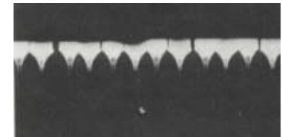
Tropfenbildung an der Spinndüse [Foto: Facharbeit Warenkunde - Die Glasfaser, www.baumann-online.de]
