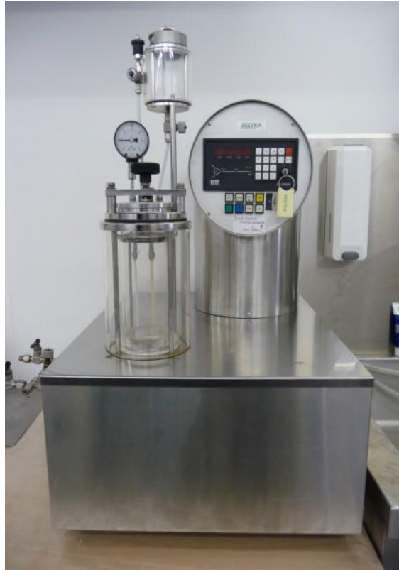
Zeltex Colorstar CS2 Färbeapparat (Zeltex AG, Basel, Schweiz) und Funktionsprinzip des Zeltex-Colorstar CS2 Färbapparates /127/
