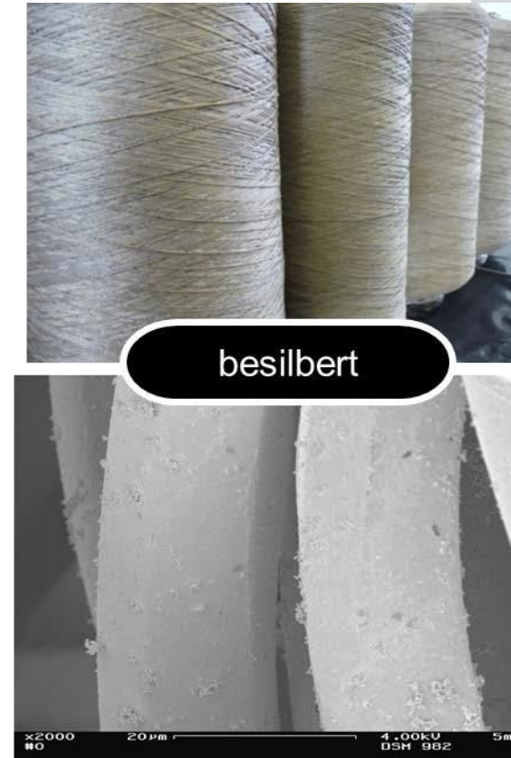
Besilbertes texturiertes PET-Garn (54/4 Nm)
