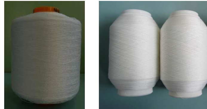
Auf eine zylindrische Färbehülse gewickelte Garne im Labormaßstab (rechts) und in der Produktion (links)
