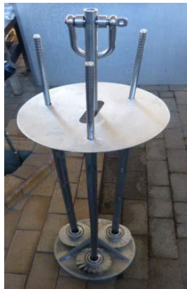
HT-Färbeapparat Vald. Henriksen B. V. mit einer Spindel (a) und mit drei Spindeln (b)
