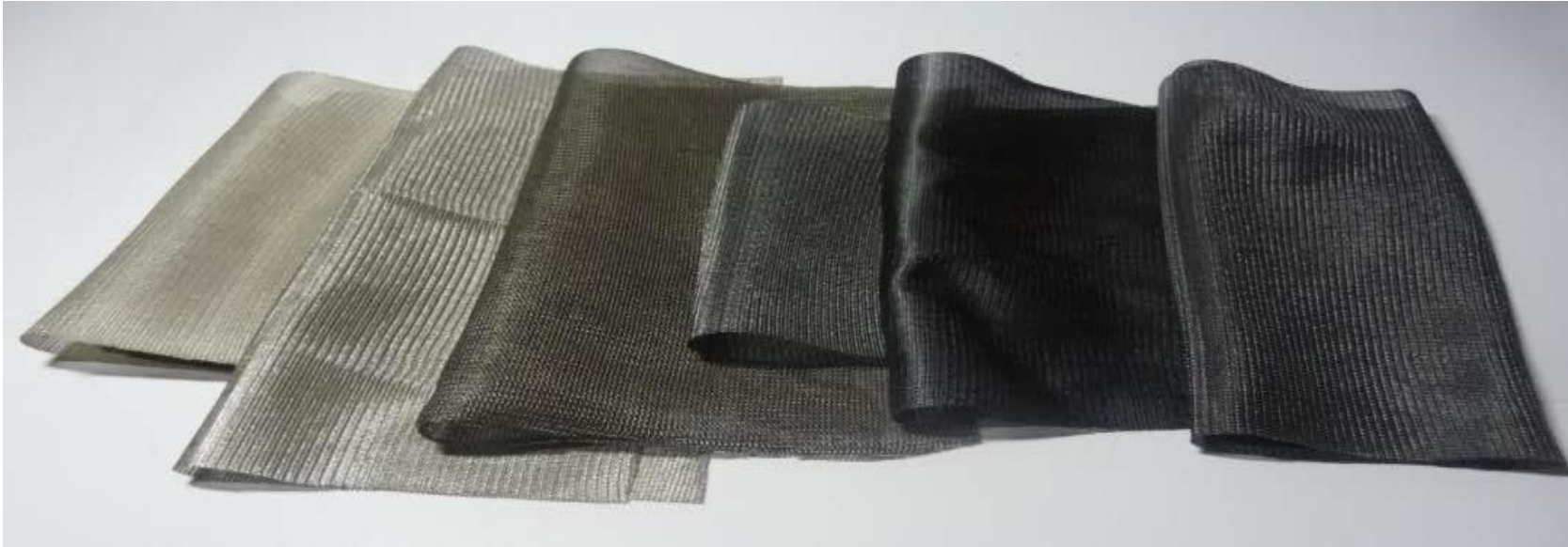
Optischer Eigenschaften mittels Einbad- und Zweibad-Verfahren behandelter PET-Gewirke
