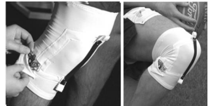
Intelligente Kniebandage mit Elektronik und einem leitfähigen Stoffstreifen, den ein Athlet trägt (CSIRO TFT, Geelong).
