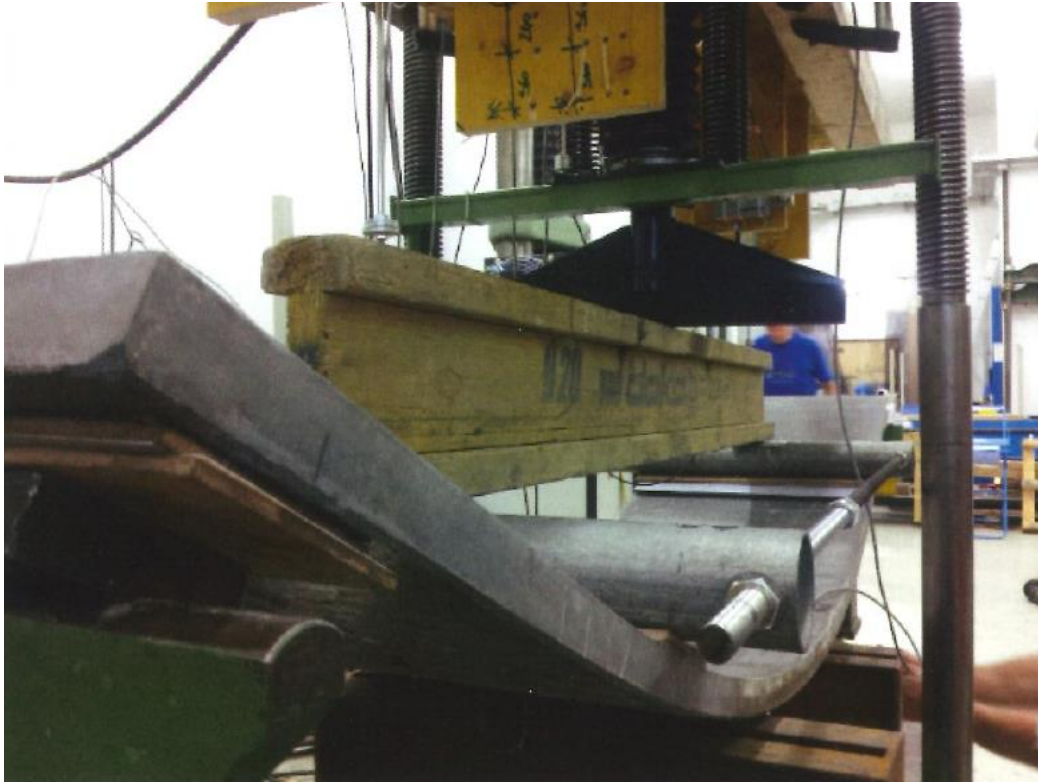
Biegeversuch an einer ultrafeinen mit einer EP-getränktem Carbondtextil bewehrten Betonplatte| © Benjamin Kromoser TU Wien, Tudalit Magazin 09/2016
