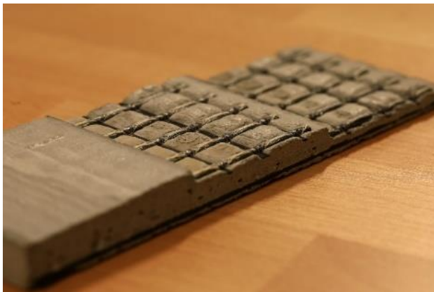
Textilbeton (links), Schematischer Prüfaufbau (rechts) | © Iris Kruppke, ITM
