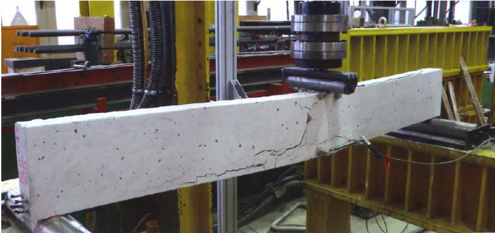
Längsrisse parallel zur textilen Bewehrung bei zyklischer Querbelastung | © IMB RWTH, Tudalit Magazin 09/2016
