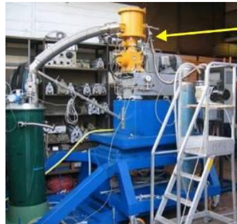
Smart Grid: Fehlerstrombegrenzer (Cesi Ricerca Milano)
