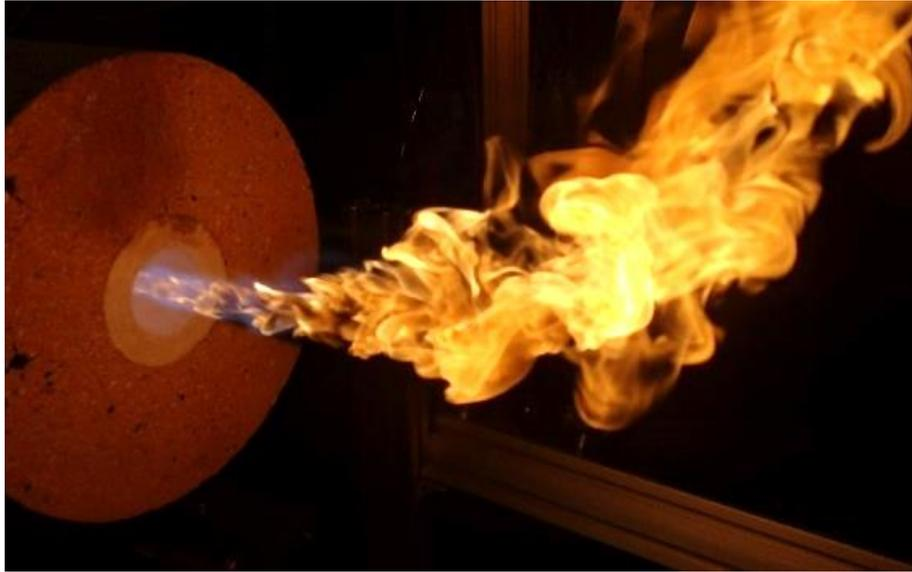
Inbetriebnahme DESAG Brenner 25 kW Erdgas/Sauerstoff
