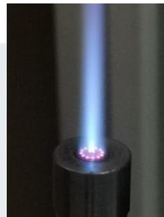
Glühen der Brennerdüse bei 100 Vol.-% H<sub>2</sub>
