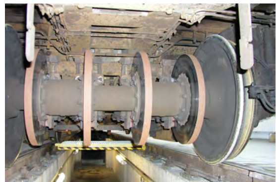
(d) Laufradsatz eines TGV mit vier unbelüfteten (massiven) Brems scheiben
