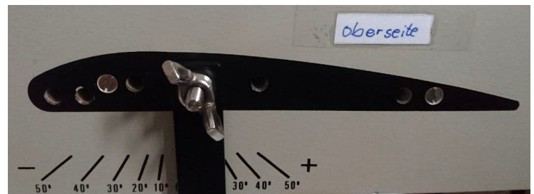
Abb. 4: Detailansicht der Winkelanzeige am Flügelmodell. Zu erkennen sind ebenfalls die Druckmessstellen (Löcher).
