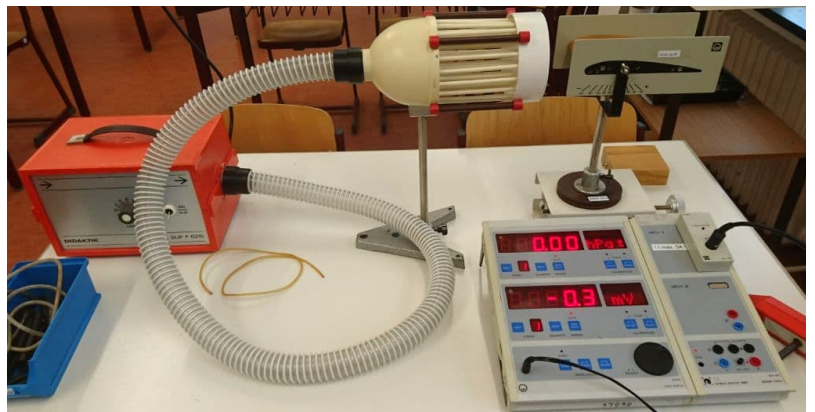
Abb. 9: Aufbau Demonstrationsexperiment zum Druck am Tragflügel. Messung erfolgt mit Cassy.
