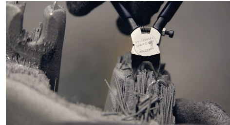
Entfernen von Stützen
