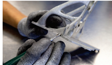
Beseitigen der Materialrückstände
