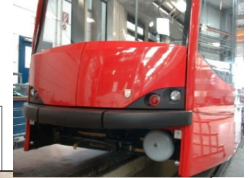
Crashabsorber aus Aluminiumschaum Schunk Sintermetalltechnik GmbH (Combindo® Bern)
