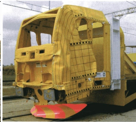
Bild 15: Deformationen am Versuchs-Frontsegment nach dem Crash-Versuch
