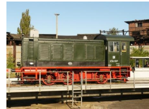
1937: WR 360 C14 mit Voith L37U (W-K-K) für 370 kW
