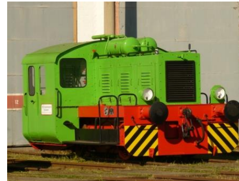
1934: Kleinlokomotive der Leistungsgruppe II (47,8 kW) mit Voith ACR 3,3 m1 (W-K)
