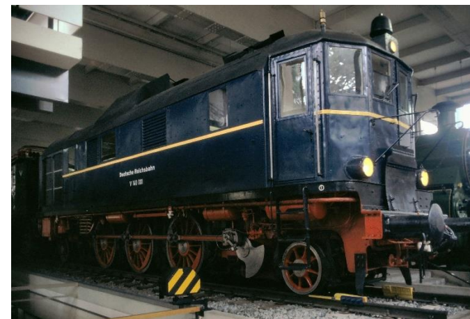
1935: V 16101 (später: V 140 001) mit Voith JJG 251 (W-K-K) für 1030 kW
