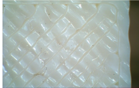
Wellige und unebene Struktur in xy-Ebene
