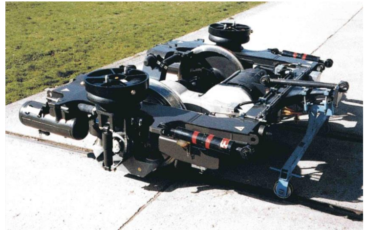
Kastengesteuertes Radsatz-Einzel-Fahrwerk (angetrieben), S-Bahn Kopenhagen
