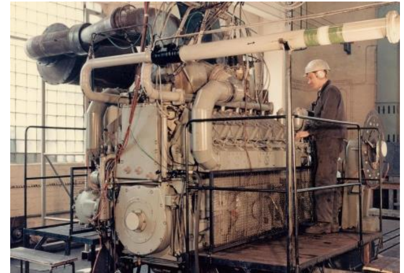
12 KVD 21 auf Prüfstand, Quelle: Archiv WTZ Roßlau
