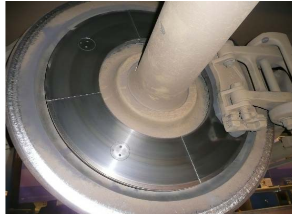
segmentierte Radbremsscheiben der Firma IBRE mit Montage
