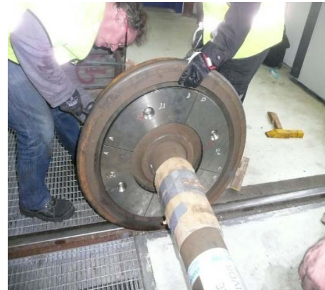
segmentierte Radbremsscheiben der Firma IBRE mit Montage
