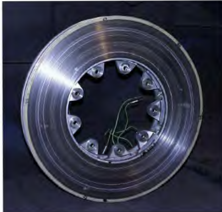
Al – MMC Bremsring WKS 640 x 100 Al nach UIC 541-3 300 km/h Programm
