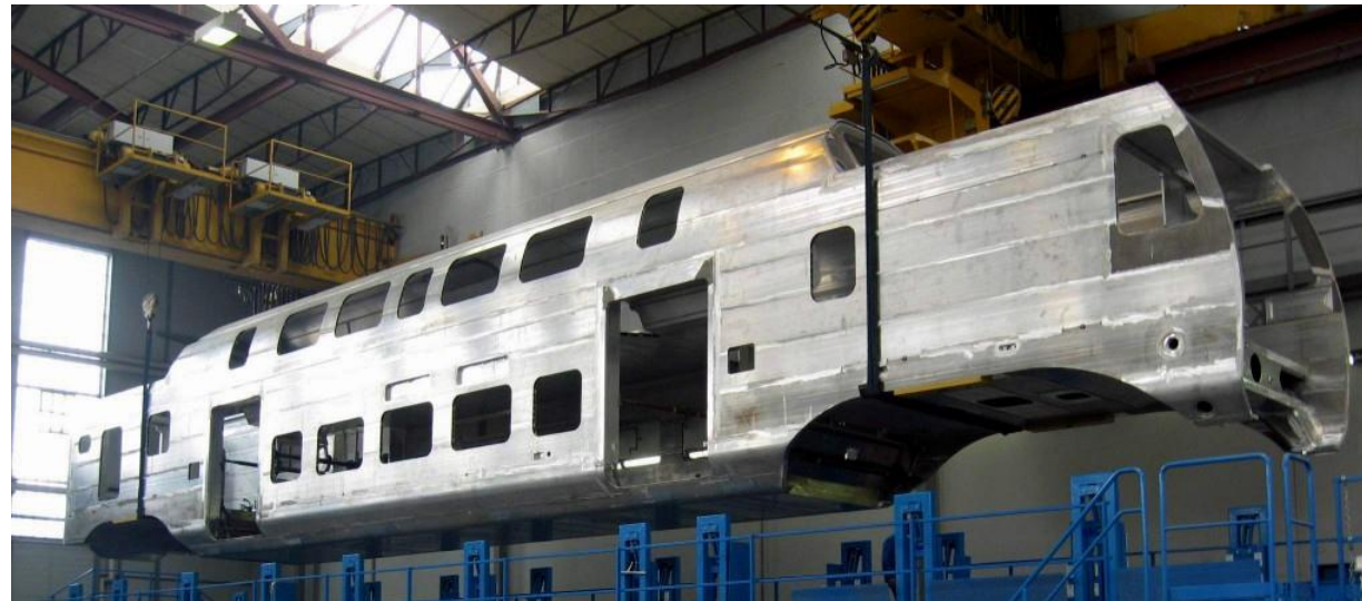
Wagenkasten Stadler KISS – Aluminium-Integralbauweise
