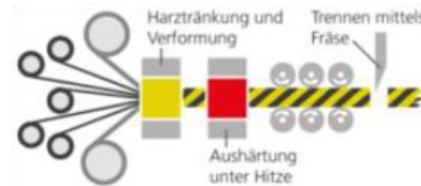
Pultrusionsverfahren
