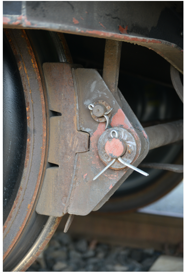
(b) Bauart Bg (hier mit Grauguss-Sohle)
