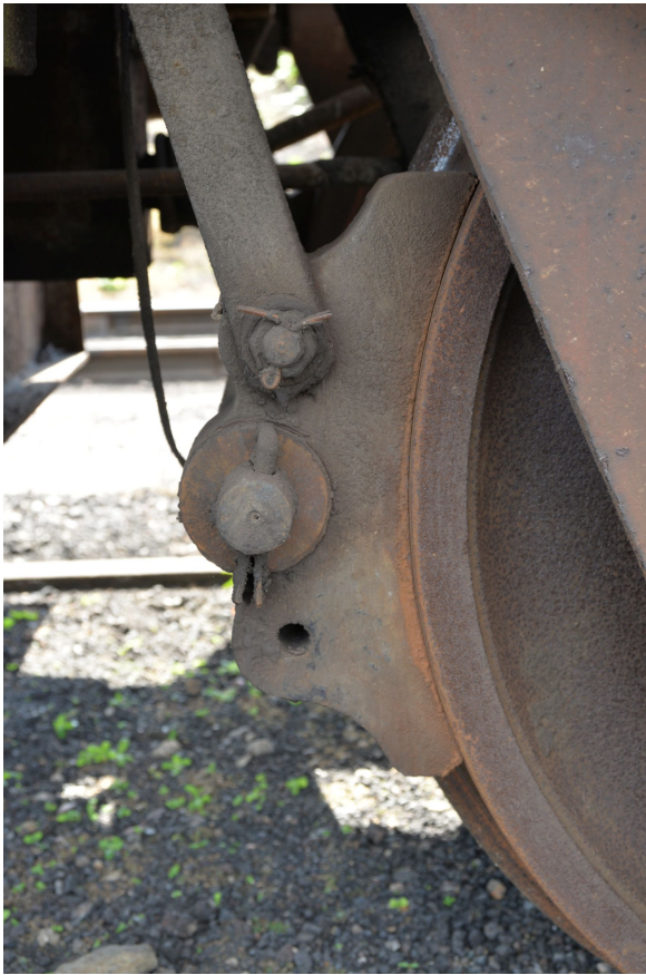
(a) Bauart B (ungeteilter Bremsklotz)
