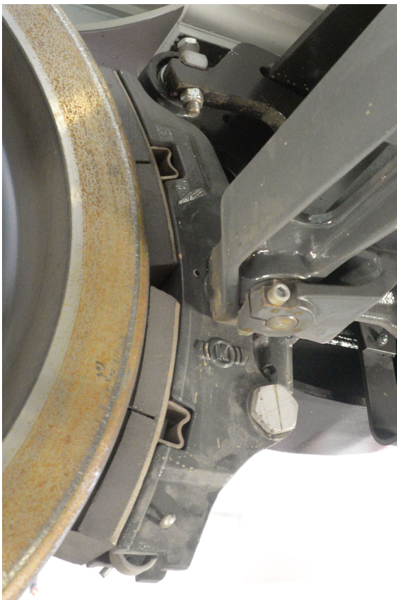
(c) Bauart Bgu (hier mit Verbundstoff-Sohlen)
