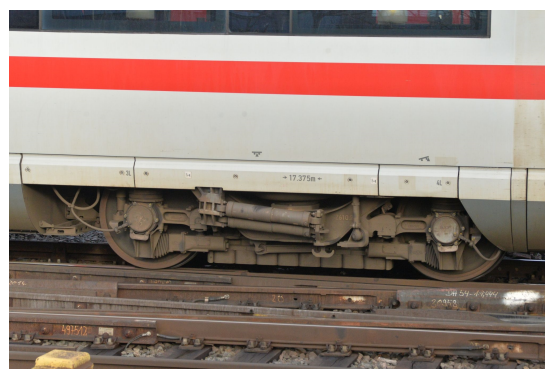
(d) Wirbelstrom(schienen)bremse (WSB)
