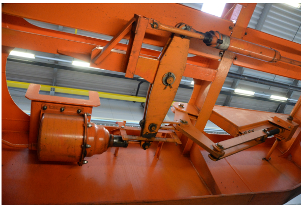
(a) Mittenbremsgestänge neuerer Bauart (Ausschnitt)
