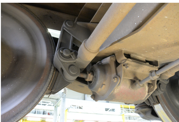
(a) Kompaktbremse älterer Bauart
