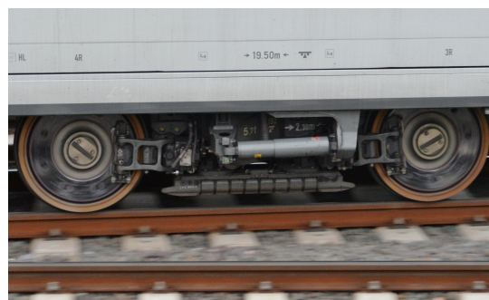
(b) Scheibenbremse und Elektromagnetschienenbremse (Mg-Bremse)
