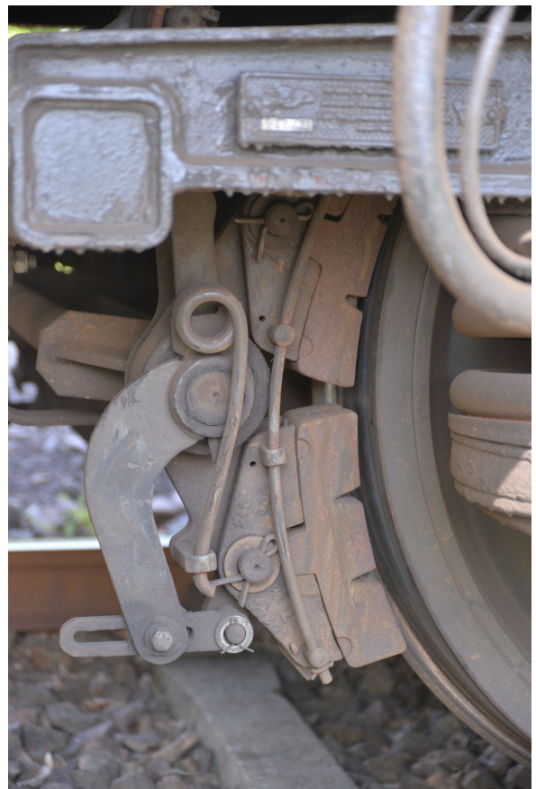
(d) Bauart Bdg (hier mit Grauguss-Sohlen)
