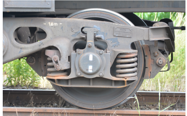
(b) beidseitig abgebremster Radsatz
