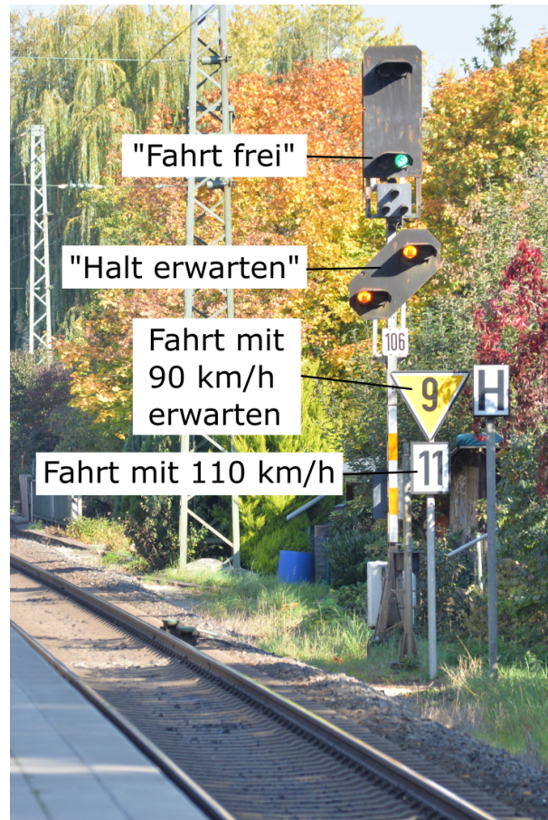
Abbildung 1.1: Eisenbahntypische Signalisierung mittels Lichtsignalen und Signaltafeln
