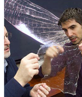
Transparenter Verbund aus Chitin und Seidenproteinen – Shriik © Harvard/ USA
