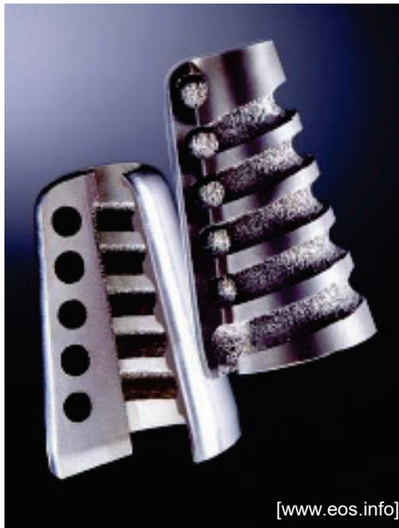
Werkzeugeinsatz mit kontur- angepassten Kühlkanälen
