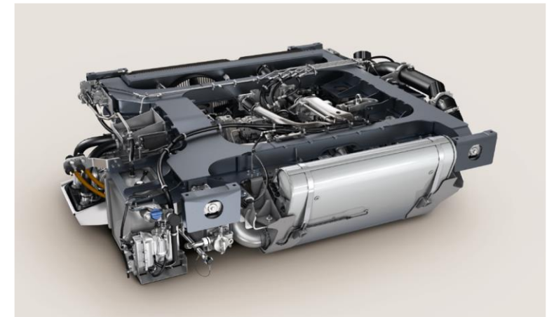
MTU Powerpack 6H 1800, Quelle: mtu-online.de
