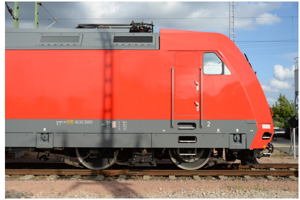
(b) Kopfpartie der BR 101 der Deutschen Bahn AG - Die Front der Lokomotive ist erkennbar angeschrägt, der Winkel jedoch steil gehalten, damit die Lücke zum ersten Folgefahrschein nicht zu groß wird.
