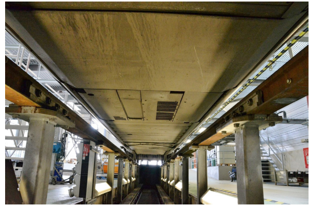
(b) Unterseite eines ICE-T-Triebzuges - Es wurde eine großflächige Verkleidung nahezu der gesamten Fahrzeugunterseite vorgenommen.
