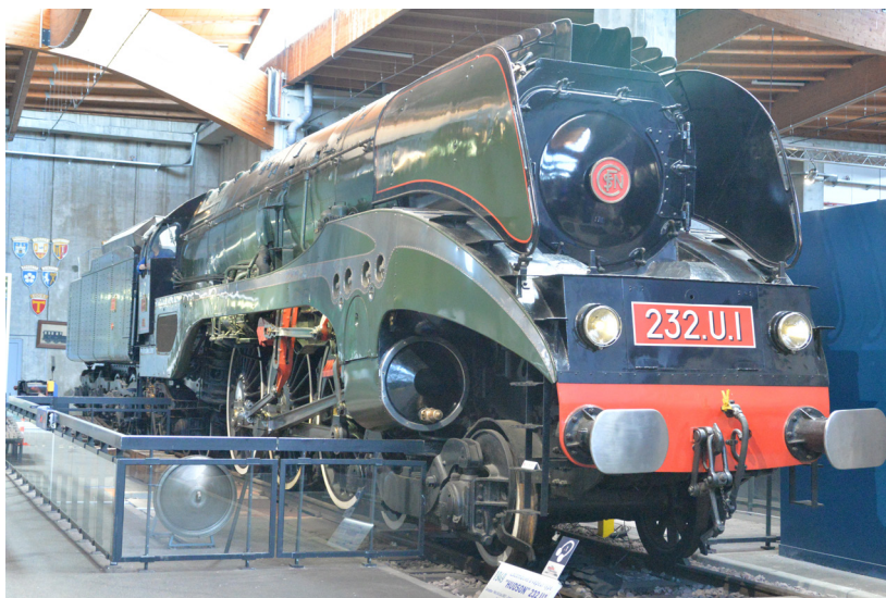
Abbildung A.9.: Reihe 232 U1 der SNCF (1949) - Französische Hochleistungs-Dampflokomotive (2,4 MW). Sie repräsentiert den am Ende der Dampflok-Epoche weitgehend akzeptierten Kompromiss, moderate Verkleidungen anzubringen, aber die Zugänglichkeit bei Fahr- und Triebwerk nicht einzuschränken.
