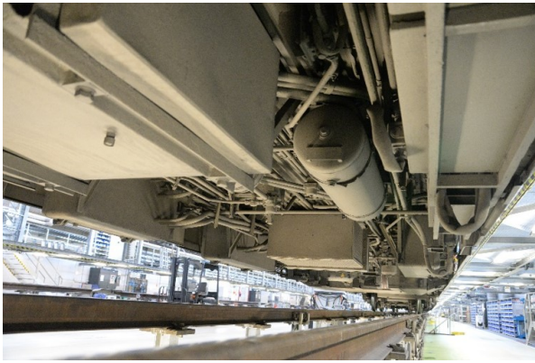
(a) Unterseite eines IC-Wagens - Es ist deutlich zu erkennen, wie zerklüftet die Flächen unter dem Fahrzeug sind. Zahlreiche Elemente der Druckluftbremse und der Klimaanlage sind ohne weitere Verkleidung montiert und sorgen für Verwirbelungen.
