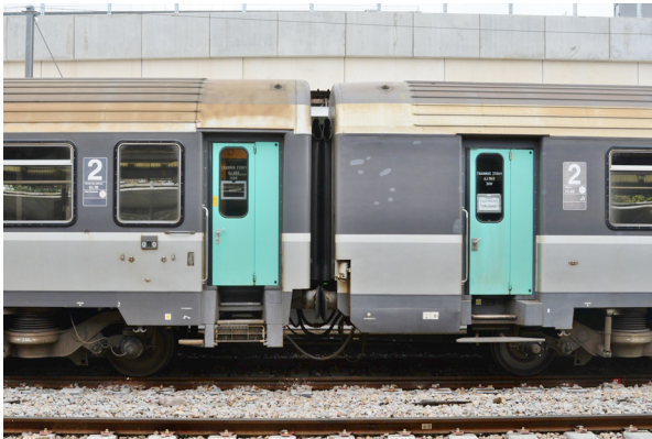
(a) Wagenübergang bei einem klassischen Wagenzug - Es ist ein deutlicher Spalt zwischen den Dächern der Wagen erkennbar und die beiden Gummibalge des Überganges schließen nicht bündig mit dem Wagenkasten ab.
