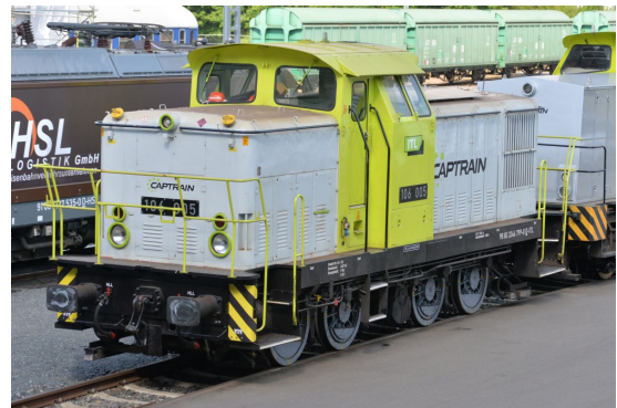
(b) BR 346 - spezifischer Gleitwiderstand: 0,0030...0,0040 (entspricht ca. 1,3...2,2 kN)
