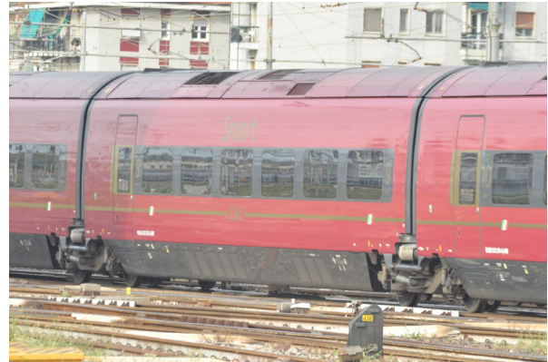
(b) Wagenübergang bei einem AGV-Hochgeschwindigkeitszug - Der Spalt zwischen den Wagen ist auf ein Minimum reduziert und die elastischen Verbindungselemente dadurch von außen praktisch kaum noch sichtbar.
