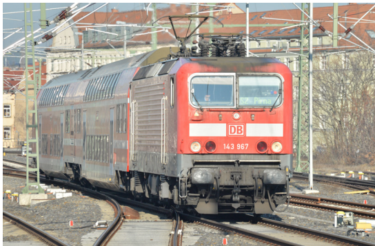
(a) BR 143 - spezifischer Gleitwiderstand: 0,0015 (entspricht ca. 1,2 kN)
