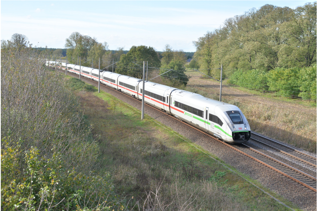
Abbildung A.14.: Zum Schluss noch eine Abbildung, die zeigt, was aus aerodynamischer Sicht nicht passieren sollte. Wenn sich die Abdeckung der Kupplung an der Fahrzeugfront aufgrund eines technischen Defektes nicht mehr schließen lässt, wird die Kupplung zwar vom Fahrtwind gut gekühlt, für die Umströmung des Fahrzeuges entehen jedoch eher suboptimale Bedingungen.
