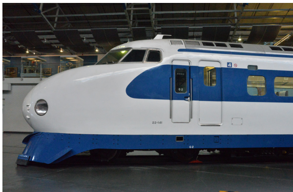
(a) Die Frontpartie eines Shinkansen-Hochgeschwindigkeitszuges der ersten Generation. Diese in den 1960er Jahren gebauten Fahrzeuge wiesen noch einen „klassischen“ Aufbau mit einem langgestreckten Vorbau und „kanzelerartigem“ Führerstand darüber auf. Bemerkenswert sind auch die tief heruntergezogenen Schürzen.
