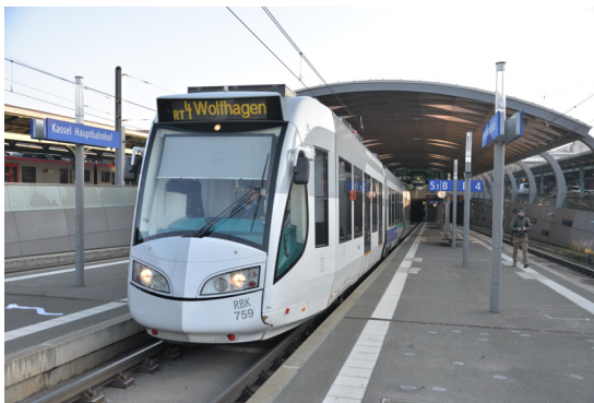
(c) Elektro-Diesel-Zweikraftfahrzeug (Alstom Citadis RegioTram Kassel)
