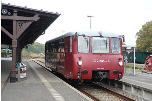
(a) Dieseltriebfahrzeug mit mechanischer Leistungsübertragung (BR 772)
