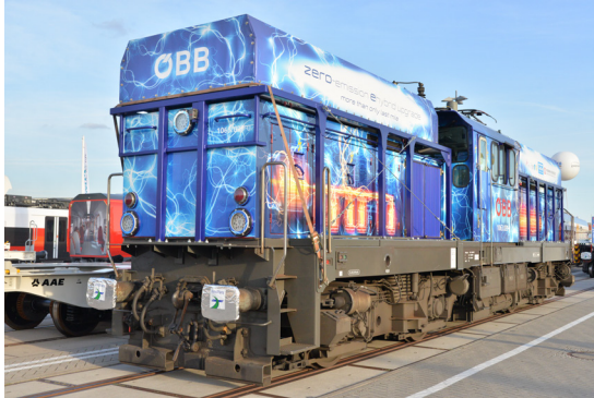
(a) Batterie-Elektrisches Zweikraftfahrzeug (BR 1063 bzw. BR 1263 der ÖBB)
