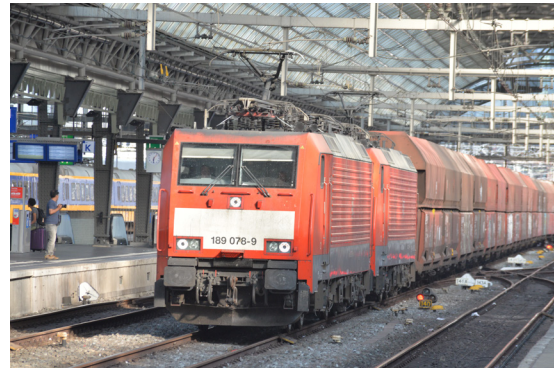
(c) BR 189 in den Niederlanden ((Deutschland: 15 kV bei 16,7 Hz und Niederlande: 1,0 kV DC))
