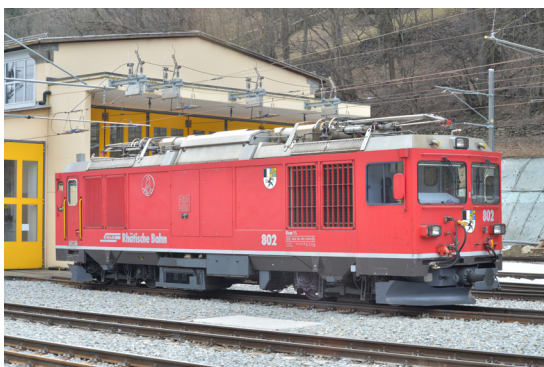
(e) Diesel-Elektro-Zweikraftfahrzeug (Gem 4/4 der RhB)
