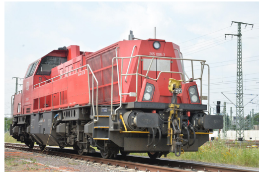
(d) Dieseltriebfahrzeug mit hydrodynamischer Leistungsübertragung (BR 265)
