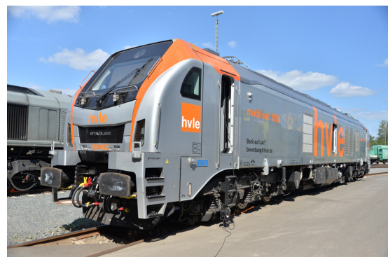
(f) Elektro-Diesel-Zweikraftlokomotive Stadler EuroDual (BR 159)
