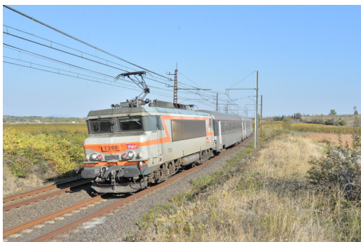
(c) 1500V-Gleichstrom-Triebfahrzeug (BB 7200 der SNCF)
