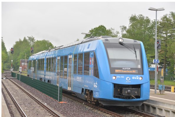
(e) Wasserstoff-Hybrid-Triebzug Alstom iLint
