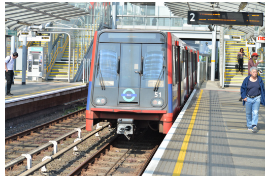
(b) Via seitlicher Stromschiene gespeister Elektrotriebzug
