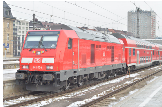
(f) Dieseltriebfahrzeug mit elektrischer AC-AC Leistungsübertragung (Drehstromantriebstechnik) (BR 245)
