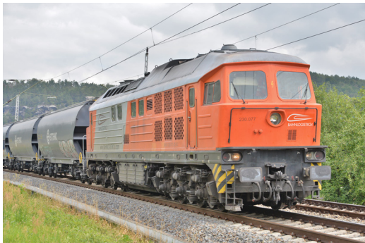
(e) Dieseltriebfahrzeug mit elektrischer AC-DC Leistungsübertragung (Drehstromsynchron-Generator und Gleichstromfahrmotoren) (BR 232)
