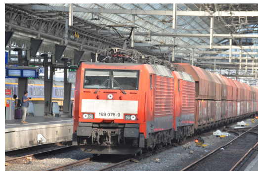
(d) Elektrisches Mehrsystemfahrzeug (BR 189)
