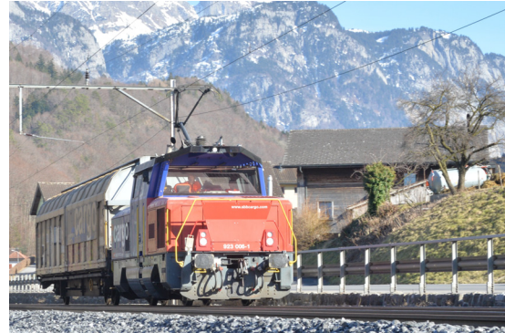
(b) Elektro-Diesel-Zweikraftfahrzeug (Eem 923 der SBB)
