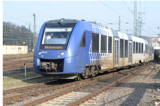
(b) Dieseltriebfahrzeug mit hydromechanischer Leistungsübertragung (BR 620)
