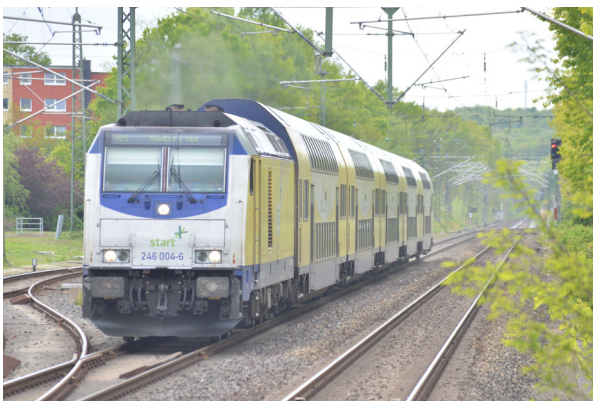
(c) BR 246 (Traxx P160 DE) - dieselelektrische Variante der Bombardier Traxx für den Reisezugverkehr
