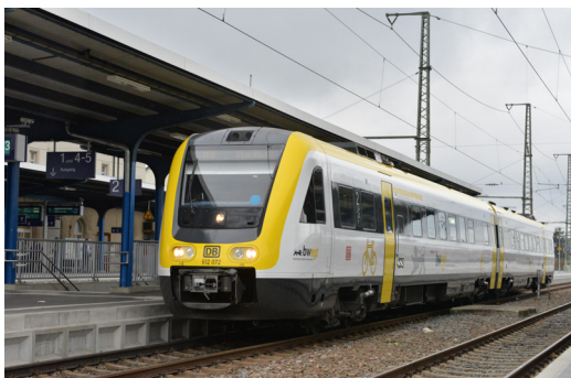
(c) Dieseltriebfahrzeug mit hydrodynamischer Leistungsübertragung (BR 612)
