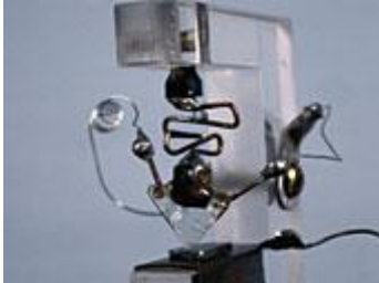
Abbildung 12: Nachbau des Ur-Transistors
