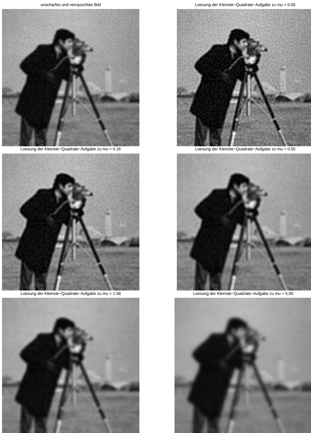
Abbildung 10.5.: Unscharfes und verrauschtes Bild (oben links) und fünf verschiedene Rekonstruktionen durch Lösung von (10.4) zu den Parametern \mu \in \{0.050, 0.158, 0.500, 1.581, 5.000\} .
