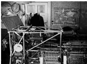
Abbildung 5: Der Prototyp, die Z1, entstand im Wohnzimmer
