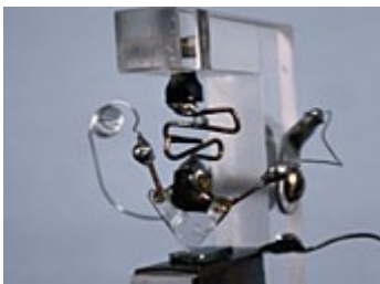
Abbildung 12: Nachbau des Ur-Transistors
