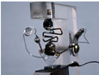
Abbildung 12: Nachbau des Ur-Transistors
