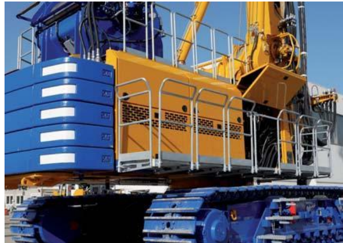
Abbildung 22 Absturzsicherungen an Großbohrgeräten
