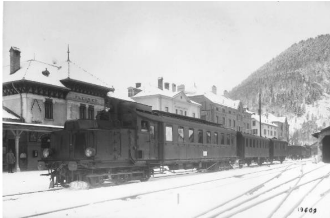
1914: DET 1 (Königl. Sächs. Staatseisenbahn) Gleichstrom-Gleichstrom – Übertragung, P_{DM} = 147 \text{ kW}
