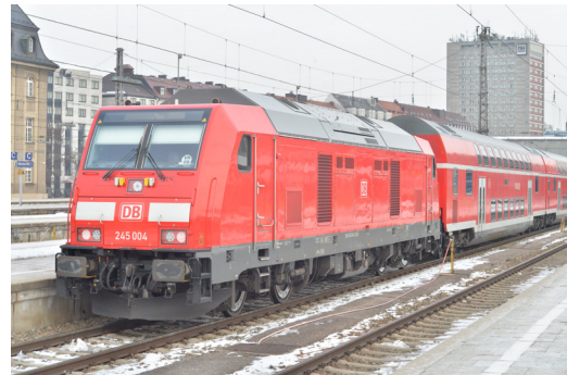
(f) Diesellokomotive mit elektrischer AC-AC Leistungsübertragung (Drehstromantriebstechnik) (BR 245)
