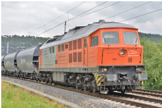
(e) Diesellokomotive mit elektrischer AC-DC Leistungsübertragung (Drehstromsynchron-Generator und Gleichstromfahrmotoren) (BR 232)
