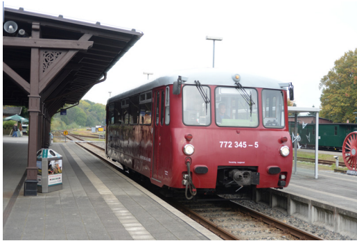
(a) Diesellokomotive mit mechanischer Leistungsübertragung (BR 772)
