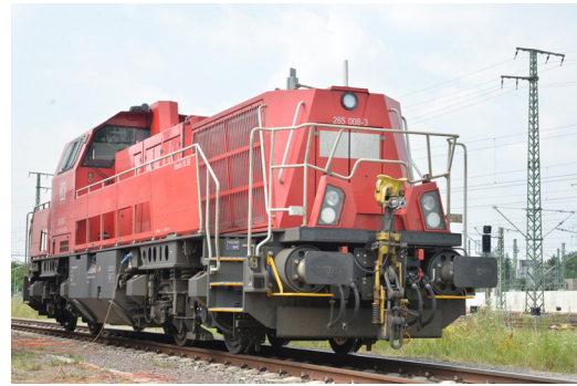
(d) Diesellokomotive mit hydrodynamischer Leistungsübertragung (BR 265)
