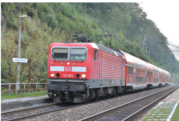
(c) BR 143 der DB AG: Phasenanschnittsteuerung
