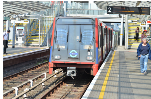
(b) Via seitlicher Stromschiene gespeister Elektrotriebzug
