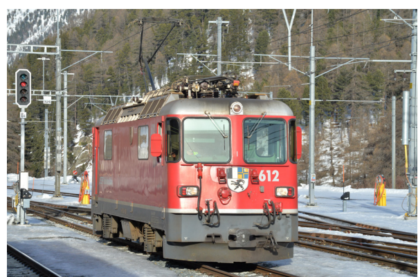
(d) Ge 4/4 II der RhB: Phasenanschnittsteuerung
