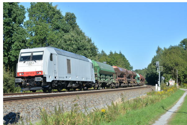
(d) BR 285 (Traxx P140 DE) - dieselelektrische Variante der Bombardier Traxx für den Güterzugverkehr
