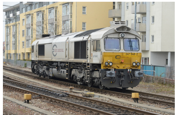
(e) AC-DC-Übertragung, Beispiel 2: Class 66
