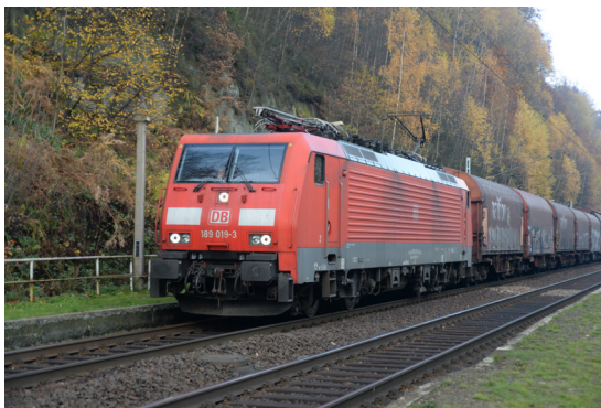
(b) BR 189 im deutsch-tschechischen Grenzverkehr ((Deutschland: 15 kV bei 16,7 Hz und Tschechische Republik (Norden): 3,0 kV DC))
