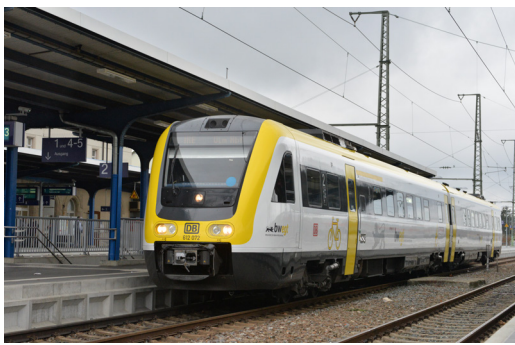
(c) Diesellokomotive mit hydrodynamischer Leistungsübertragung (BR 612)
