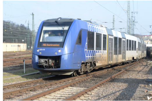
(b) Diesellokomotive mit hydromechanischer Leistungsübertragung (BR 620)
