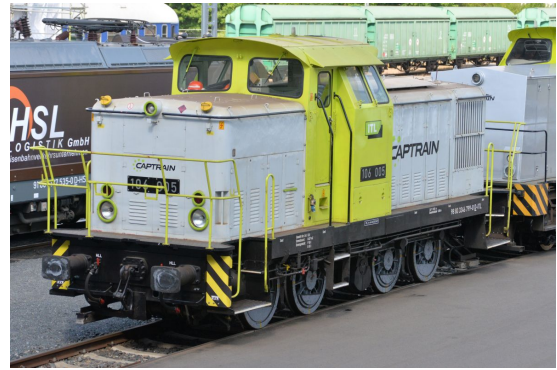
(b) BR 346 - spezifischer Gleitwiderstand: 0,0030...0,0040 (entspricht ca. 1,3...2,2 kN)
