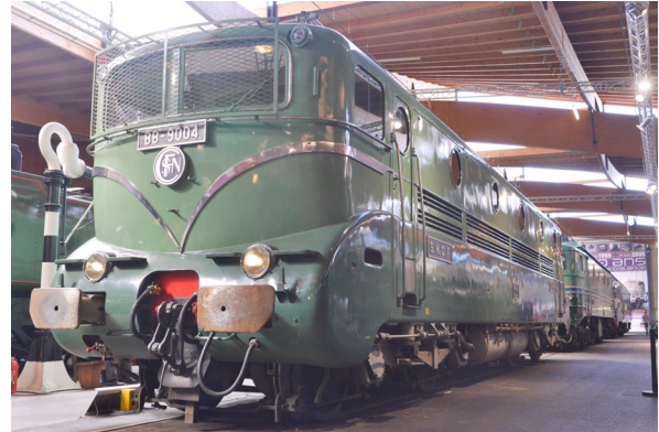
(b) Die BB 9004 ist eine Weltrekordlok und erreichte 1955 eine Geschwindigkeit von 331 km/h. Der Zug, vor dem die Lokomotive lief wurde eigens präpariert, damit der Luftwiderstand gesenkt werden konnte. So wurde beispielsweise durch zusätzliche Hauben ein bündiger Übergang von der Lokomotive zum Wagenzug hergestellt.
