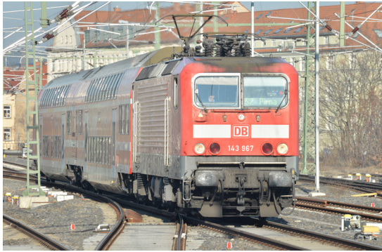
(a) BR 143 - spezifischer Gleitwiderstand: 0,0015 (entspricht ca. 1,2 kN)
