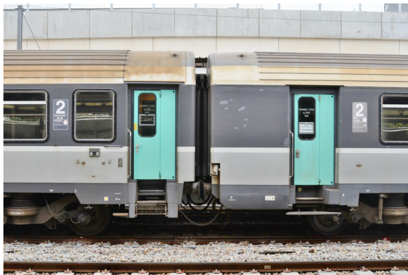
(a) Wagenübergang bei einem klassischen Wagenzug - Es ist ein deutlicher Spalt zwischen den Dächern der Wagen erkennbar und die beiden Gummibälge des Überganges schließen nicht bündig mit dem Wagenkasten ab.
