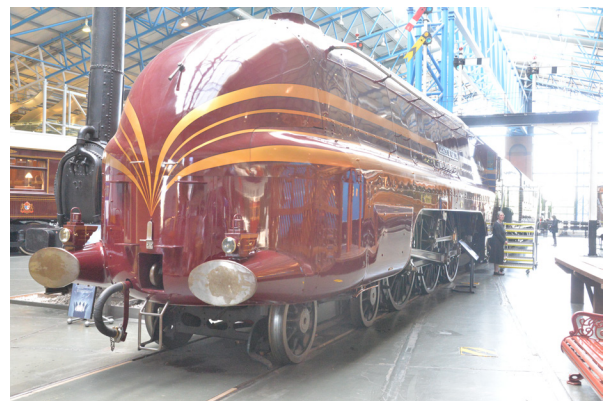
(b) LMS „Coronation“ Class - Die Gesellschaft LMS war ein „Marktbegleiter“ der LNER und wollte nach dem Erfolg der A4 ebenfalls eine werbeträchtige „Stromlinienlok“ haben. Das Ergebnis ist ästhetisch durchaus gelungen und war auch bezüglich der Verringerung des Luftwiderstandes ein Erfolg, brachte aber die Lokführer zur Verzweiflung, weil der Rauch aus dem Schornstein nicht zuverlässig aus ihrem Sichtbereich geleitet wurde. Auch damals gab es also schon Zielkonflikte bei der aerodynamischen Optimierung.
