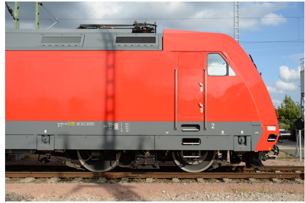
(b) Kopfparte der BR 101 der Deutschen Bahn AG - Die Front der Lokomotive ist erkennbar angeschrägt, der Winkel jedoch steil gehalten, damit die Lücke zum ersten Folgefahrzeug nicht zu groß wird.
