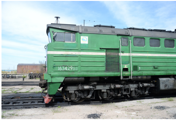
(a) Kopfparte einer kasachischen TEM10-Güterzuglokomotive - Bei der Gestaltung dieser Fahrzeuge in der damaligen Sowjetunion dürften aerodynamische Erwägungen kaum eine Rolle gespielt haben.
