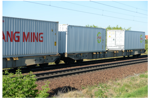
(b) Containertragwagen - Durch die unvollkommene Beladung des Wagens entsteht eine Lücke und dadurch ein zusätzlicher doppelter Querschnittswechsel.
