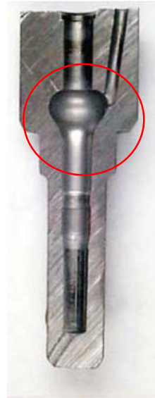
Einbringen eines kugelförmigen Hohlraumes zur Verbindung der beiden Kanäle
