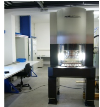
PECM-Anlage mit Wannenkonstruktion
