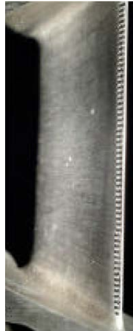
ECF Bohrungen \varnothing 0,2 mm 61 Filmkühlungsbohrungen gleichzeitig unter spitzem Winkel (Turbinenschaufel)
