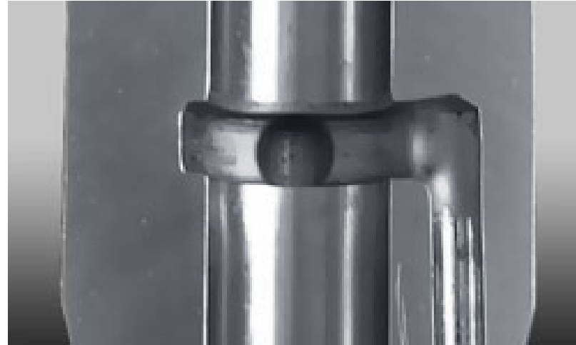
Herstellung der Verbindung von Kraftstoffzulaufbohrung zur Hauptbohrung bei Einspritzdüsen
