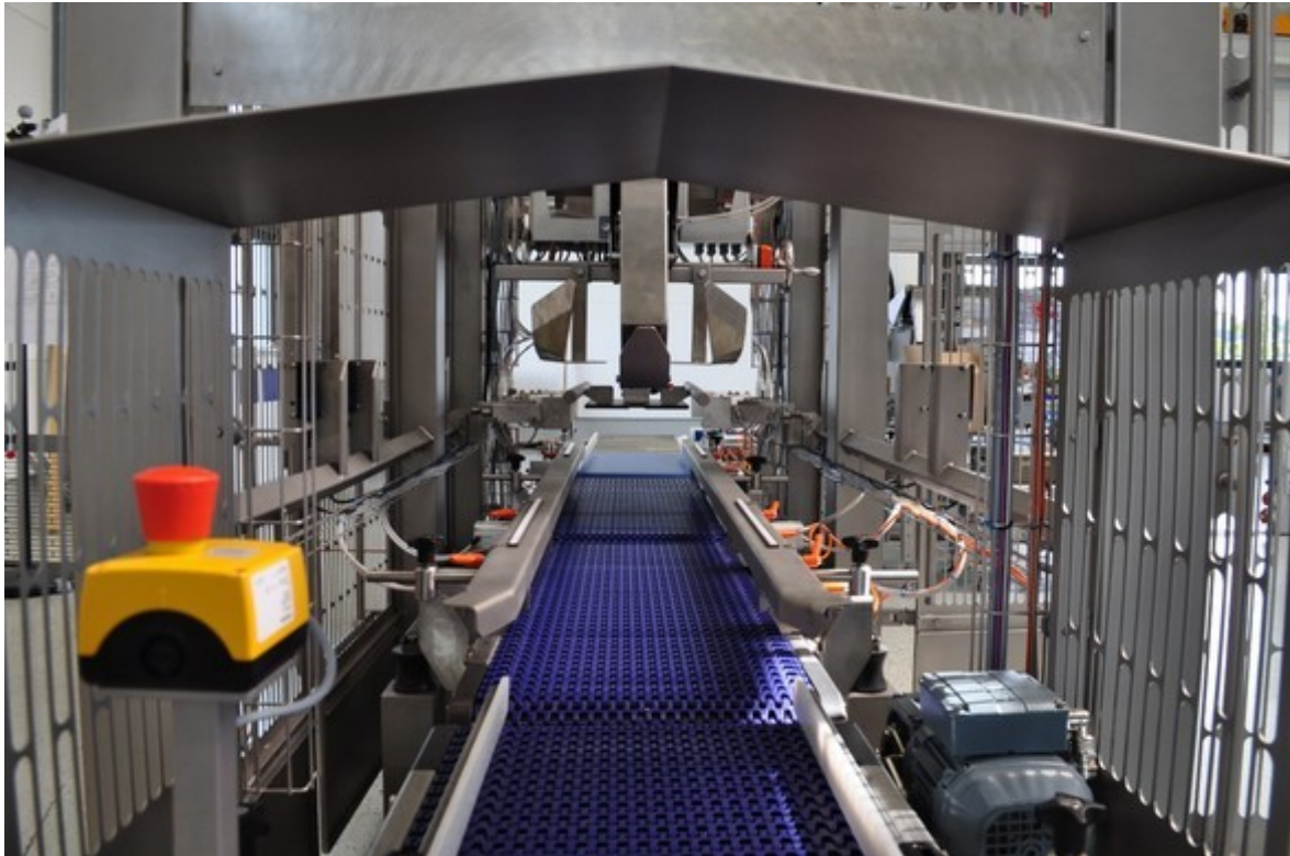
Verpackungsanlage - Andrück- und Rüttelstation
