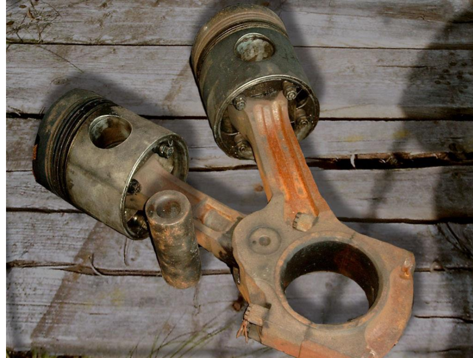
Anlenkpleuel des Dieselmotors Kolomna 5D49 V16
