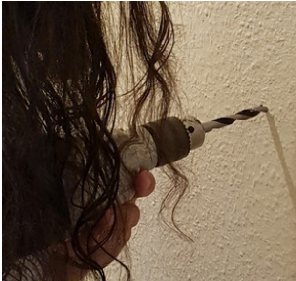
Abb. 5.3 Gefährdung beim Bohren mit offenen langen Haaren
