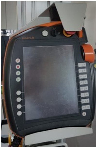
Abb. 3.3 Handbediengerät des Industrieroboters (Hersteller: KUKA AG)
