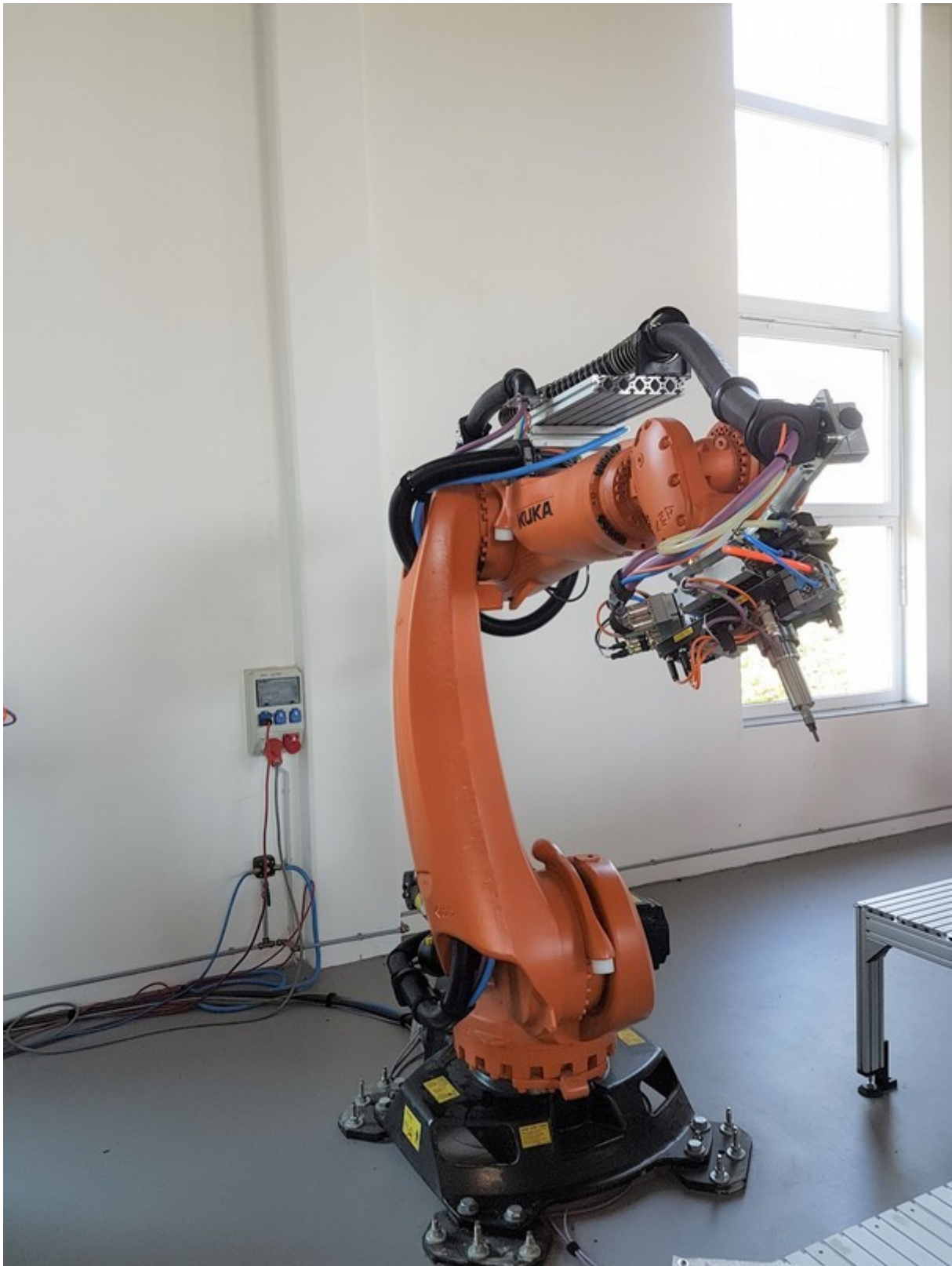
Feststehender 6-achsiger Industrieroboter mit angetriebenem Werkzeug
