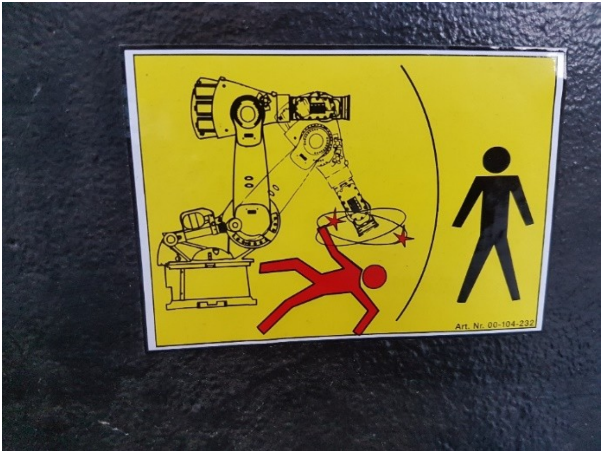
Abb. 6.4 Sicherheitskennzeichnung am Sockel des Industrieroboters
