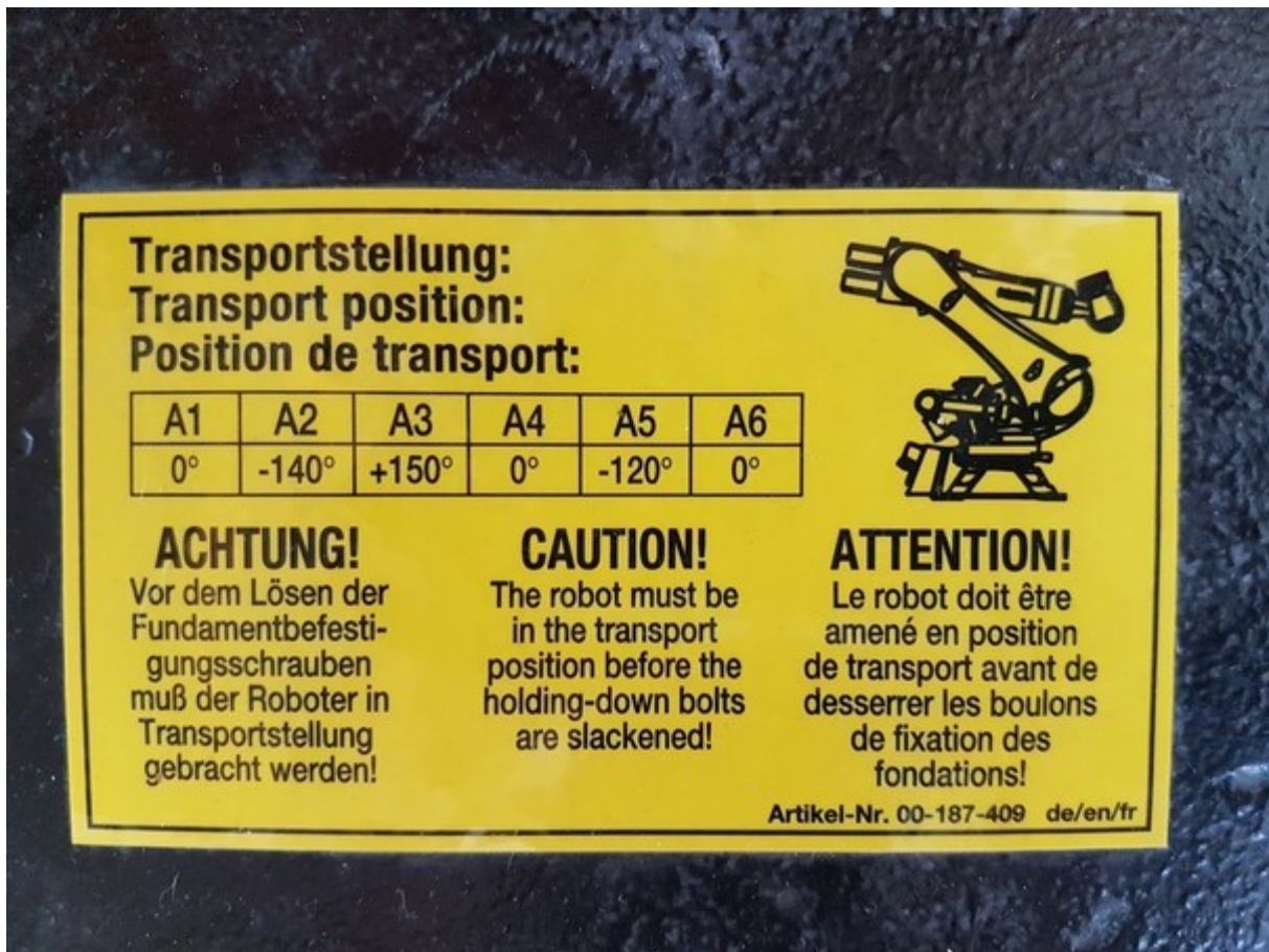
Abb. 7.5 Piktogramme und Warnhinweise am Industrieroboter
