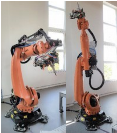
Abb. 3.2 Industrieroboter in Grundstellung und in senkrechter Ausstreckung (Hersteller: KUKA AG)
