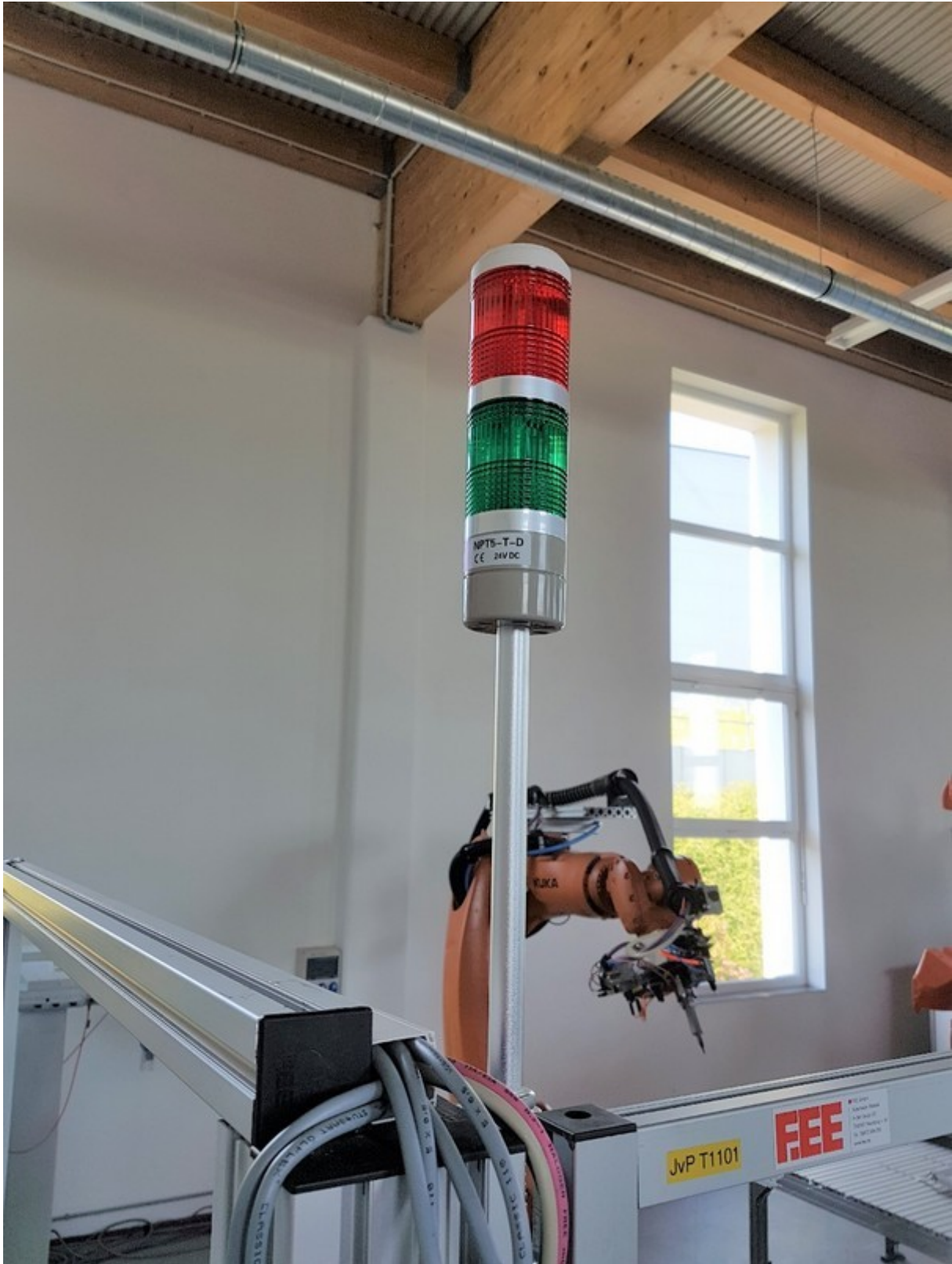
Abb. 7.4 Anbringung von Signalleuchten am Industrieroboter
