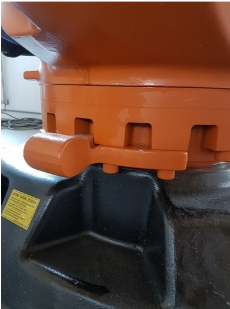
Abb. 7.1 Mechanischer Endanschlag am Industrieroboter
