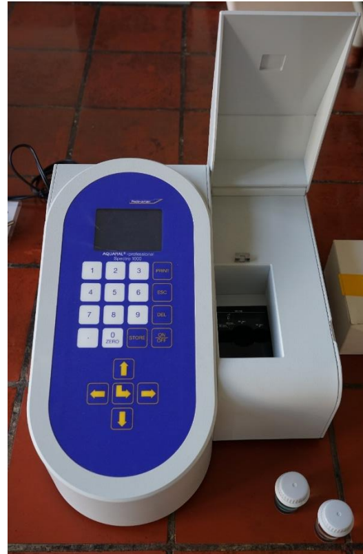
Aquanal® Spectro 1000 Tisch-Spektrofotometer (Riedel-de Haën) Wellenlängenbereich: 330-900 nm Messung: Absorption, Transmission
