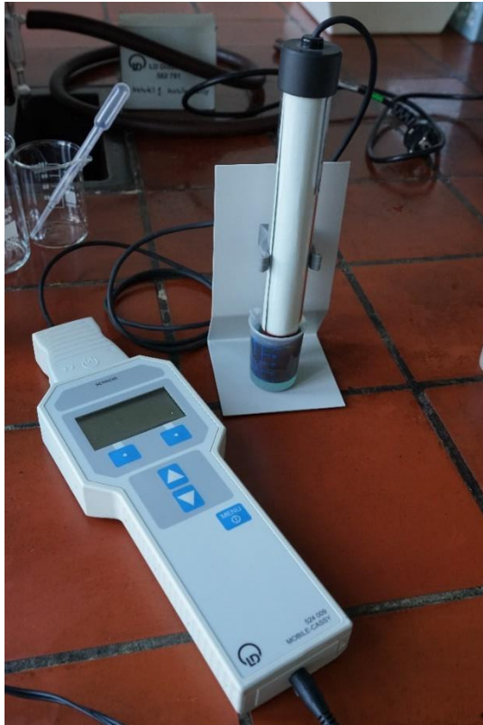
Leybold Didactic Mobile Cassy Sensor Wellenlängenbereich: 455-700 nm Messung: Transmission
