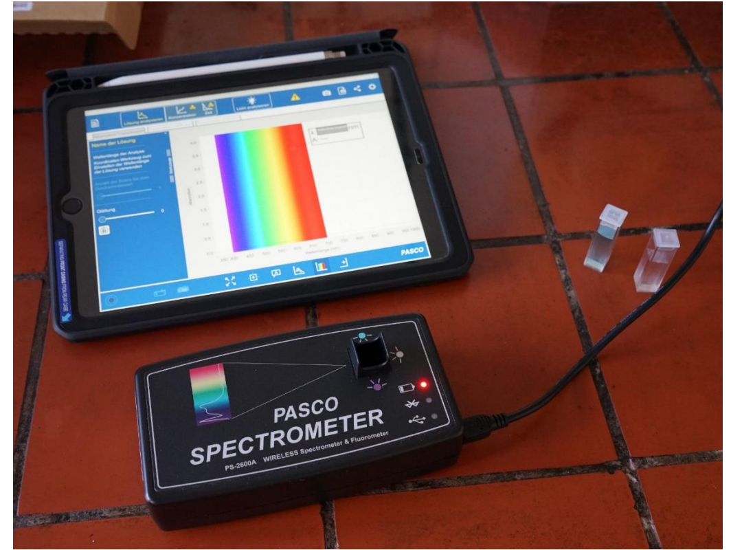
Pasco Bluetooth Spektrometer Wellenlängenbereich: 380-950 nm Messung: Absorption, Transmission, Fluoreszenz (+ Intensität)
