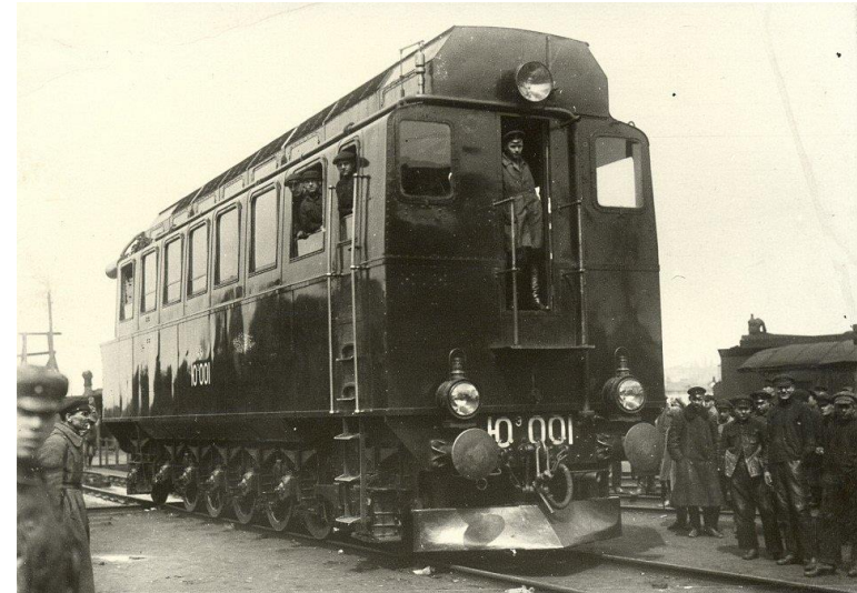
1923/24: E el 2 (Maschinenfabrik Esslingen) Gleichstrom-Gleichstrom – Übertragung, P_{DM} = 883 \text{ kW} , P_T = 800 \text{ kW}
