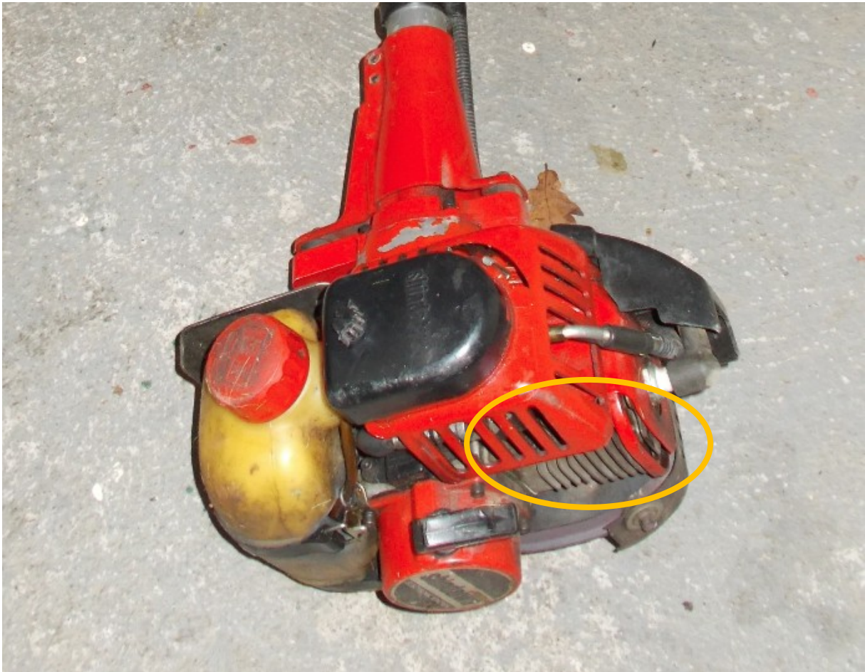
Abb. 6.3: Schalldämpfer an der Antriebseinheit des Freischneiders
