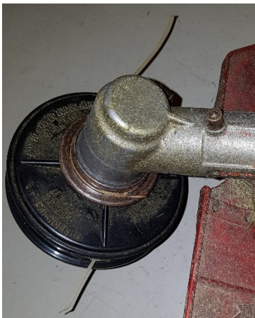
Abb. 4.2 Fadenspulkopf eines Freischneiders mit Schneidfäden
