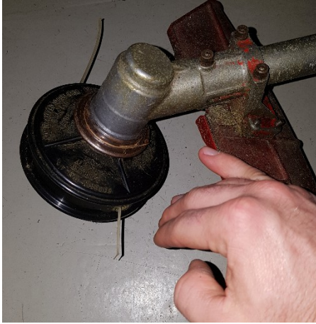
Abb. 4.3 Gefährdung durch Schneidfäden eines Freischneiders
