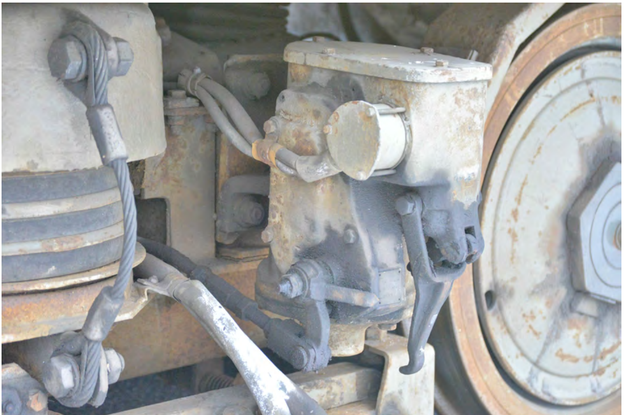
Abbildung 5.33: Federspeicher-Solenoid-Bremse an einem Tatra T4 Straßenbahn-Triebwagen
