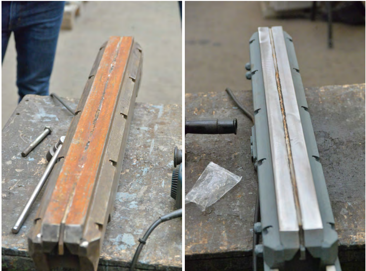
(a) Bremsmagnet mit Aufschieferungen vor der (b) Bremsmagnet nach der Aufarbeitung im Rahmen der Fahrzeuginstandhaltung Aufarbeitung
