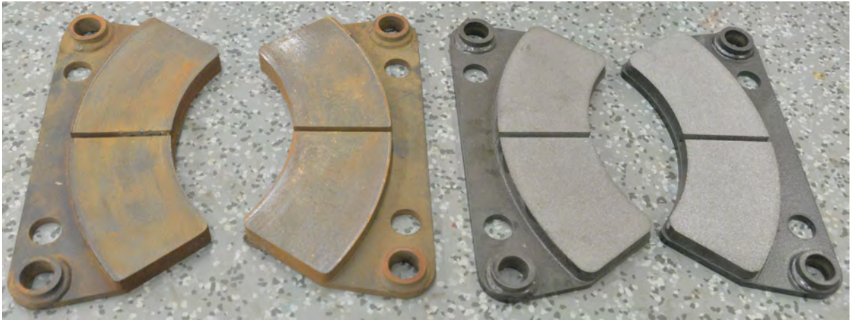
Abbildung 5.35: Gegenüberstellung von eingeschliffenen (links im Bild) und fabrikneuen Bremsbelägen für eine Straßenbahn-Scheibenbremse
