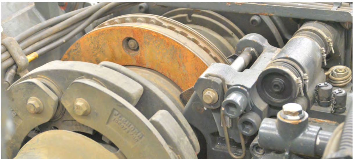
Abbildung 5.36: Eingebaute Bremsscheibe in einem Straßenbahnfahrwerk. Die Bildung einer reibwertverändernden Zwischenschicht (Flugrost) ist deutlich erkennbar.
