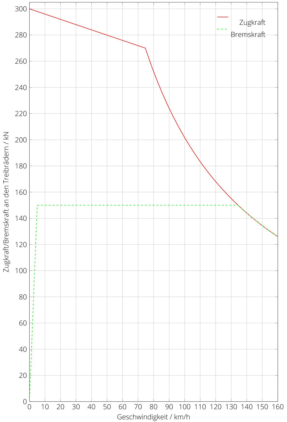
Abbildung 0.1: Zug- und Bremskraft-Diagramm der betrachteten Lokomotive
