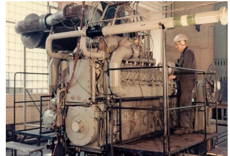
12 KVD 21 auf Prüfstand, Quelle: Archiv WTZ Roßlau
