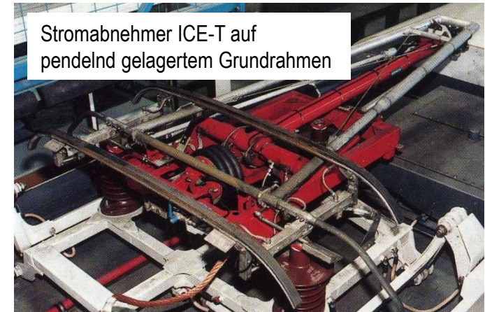
Abb. 7: Stromabnehmerjoch auf Drehgestellrahmen (Beispiel ICT)
