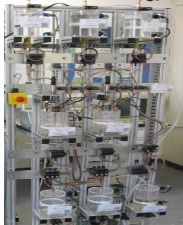
Abbildung : Laboranlage der TU Dresden als Übungsfeld für moderne Prozessleittechnik
