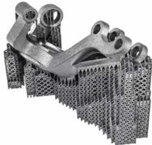
Metallbauteil mit Stützstruktur
