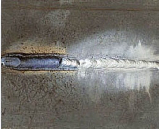
Elektroden-Schweißnaht vor und nach der Bearbeitung mit Schlackenhammer und Drahtbürste (von links)
