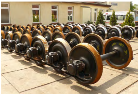
(a) Radsätze für Güterwagen mit Klotzbremsen
