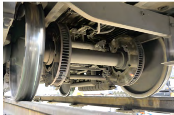
(b) Radsatz eines IC-Wagens mit zwei innenbelüfteten Brems scheiben
