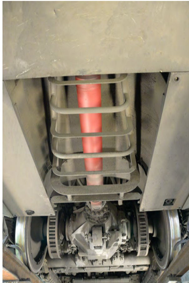
Abbildung 2.12: Radsatzantrieb eines ICE-T
