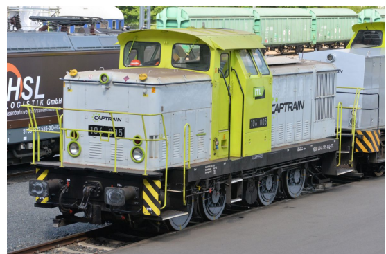
(b) BR 346 - spezifischer Gleitwiderstand: 0,0030...0,0040 (entspricht ca. 1,3...2,2 kN)
