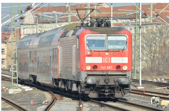
(a) BR 143 - spezifischer Gleitwiderstand: 0,0015 (entspricht ca. 1,2 kN)
