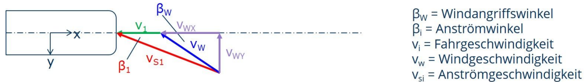
Abbildung 4.12: Anströmwinkel \beta_i in Abhängigkeit der Fahrzeuggeschwindigkeit bei Windangriffswinkel \beta_W
